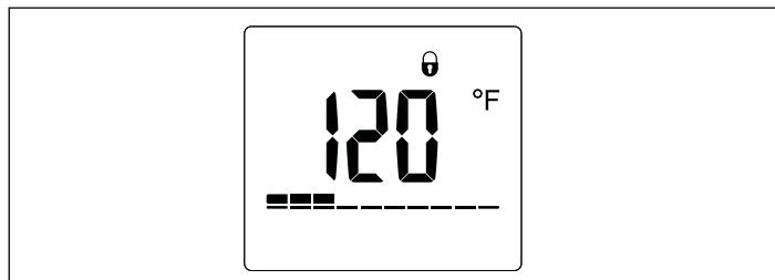
Si le verrouillage de l'écran est actif, un symbole de verrouillage apparaîtra sur l'écran de base, et aucun paramètre ne pourra être modifié. Pour désactiver le verrouillage, maintenez la touche  $T_{max}$
