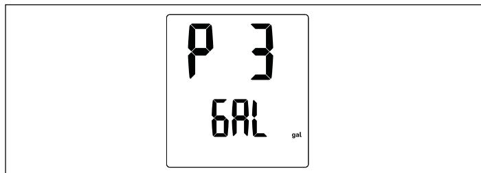
Se indica la unidad actual de volumen y el valor parpadea con el fin de indicar que se puede modificar. Para cambiar el valor de galones por minuto a litros por minuto y viceversa, gire la perilla de control.
