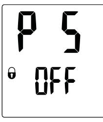
Si le paramètre de verrouillage de l'affichage est réglé sur «On» et que l'utilisateur maintient le bouton d'information pendant 5 secondes ou laisse l'affichage s'éteindre pendant 15 secondes, le verrouillage de l'affichage devient actif.
