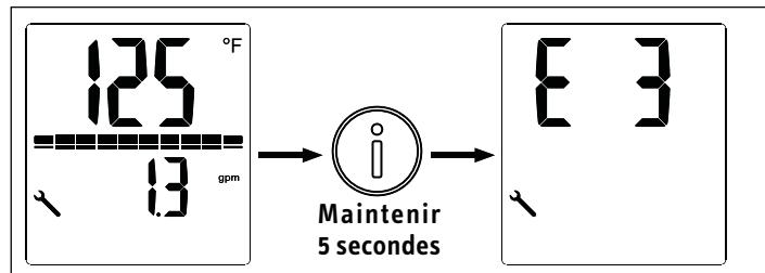
Pendant que la clé est affichée, appuyez sur le bouton «Information» (DHC-E Plus) ou sur le bouton  $T_{max}$  (DHC-E Trend) pendant cinq secondes pour faire avancer l'affichage jusqu'à la page d'affichage des erreurs. Voir section 16, «Dépannage», pg. 79, pour obtenir des informations sur la manière d'interpréter le code d'erreur signalé.
