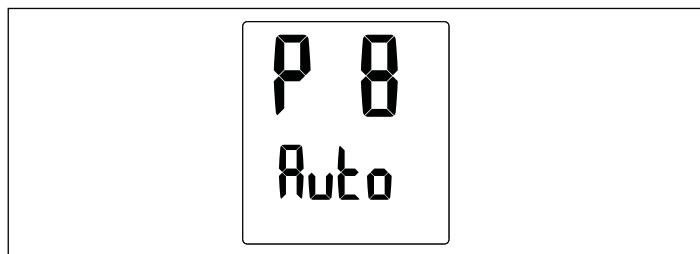
La pantalla en su totalidad y la retroiluminación comenzarán a parpadear, con el fin de indicar que el valor puede modificarse girando la perilla de control. Cuando el valor está ajustado en "Auto", se desactivará automáticamente después de 30 segundos de inactividad.
