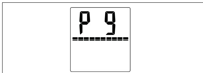
La barra de estado de la capacidad de potencia indica el ajuste de brillo. Una barra a plena capacidad indica que el brillo está en la configuración alta. Una barra a capacidad media indica que el brillo está en el ajuste bajo.
