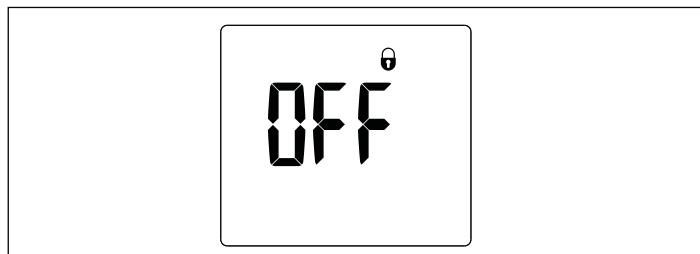
Si le paramètre de verrouillage de l'affichage est réglé sur «On» et que l'utilisateur maintient la touche  $T_{max}$  enfoncee pendant 5 secondes ou laisse l'affichage s'éteindre pendant 15 secondes, le verrouillage de l'affichage devient actif.
