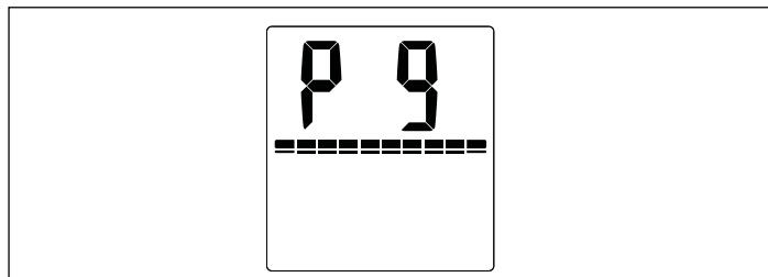
La barre d'état de la capacité d'alimentation indique le réglage de la luminosité. Une barre de pleine capacité indique que la luminosité est au réglage élevé. Deux barres de capacité indiquent que la luminosité est en position basse.
