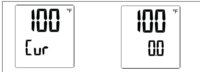
El ahorro acumulado se actualiza diariamente y muestra el ahorro estimado para el usuario en comparación con una instalación en la que se utilizó un calentador de agua tipo tanque de 50 galones.
