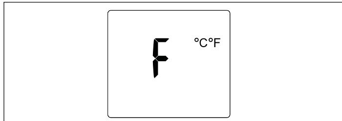
Se visualiza la unidad actual y el valor para la pantalla secundaria parpadea con el fin de indicar que se puede modificar tal valor. Para cambiar el valor de Fahrenheit a Celsius y viceversa, debe girarse la perilla de control.
