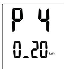
L'affichage secondaire clignote pour indiquer que la valeur peut être modifiée en tournant le bouton de commande. Consultez votre facture d'électricité pour déterminer le coût de l'électricité par kWh.
