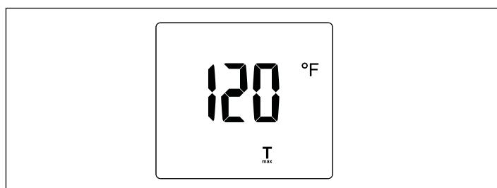
En el menú de ajuste de T<sub>max</sub>, la pantalla parpadea, lo que indica que se puede cambiar el valor girando la perilla de control. El valor T<sub>max</sub> puede aumentarse girando la perilla de control hacia la derecha y disminuirse girándola hacia la izquierda. El valor T<sub>max</sub> puede desactivarse al girar la perilla de control hacia la izquierda, pasando la opción de 20 °C (68 °F). En la pantalla se indicará "Off" si el valor T<sub>max</sub> está inactivo.
