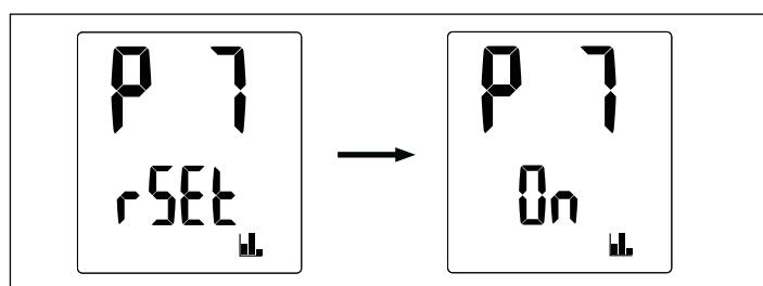
L'affichage clignote pour indiquer que la valeur peut être modifiée en tournant le bouton de commande. Pour réinitialiser, appuyez d'abord sur les deux boutons 1 et 2 pendant 5 secondes, « On » apparaît alors. Ensuite, appuyez sur le bouton d'information pendant 5 secondes pour réinitialiser.
