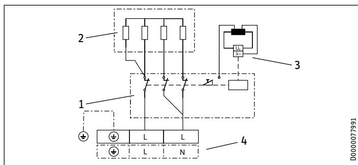
1 Circuit imprimé de puissance avec interrupteur de sécurité intégré
