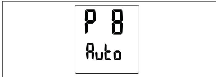
Tout l'affichage et le rétro-éclairage clignotent pour indiquer que la valeur peut être modifiée en tournant le bouton de commande. Lorsque la valeur est réglée sur «On», le rétro-éclairage est toujours allumé. Lorsque la valeur est réglée sur «Auto», il se désactive automatiquement après 30 secondes d'inactivité.
