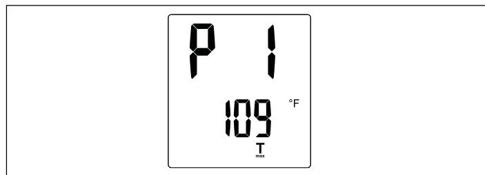
En el menú de ajuste de T<sub>max</sub>, la pantalla parpadea, lo que indica que se puede cambiar el valor girando la perilla de control. El valor T<sub>max</sub> puede aumentarse girando la perilla de control hacia la derecha y disminuirse girándola hacia la izquierda. El valor T<sub>max</sub> puede desactivarse al girar la perilla de control hacia la izquierda, pasando la opción de 68 °F (20 °C). En la pantalla se indicará "Off" si el valor T<sub>max</sub> está inactivo.
