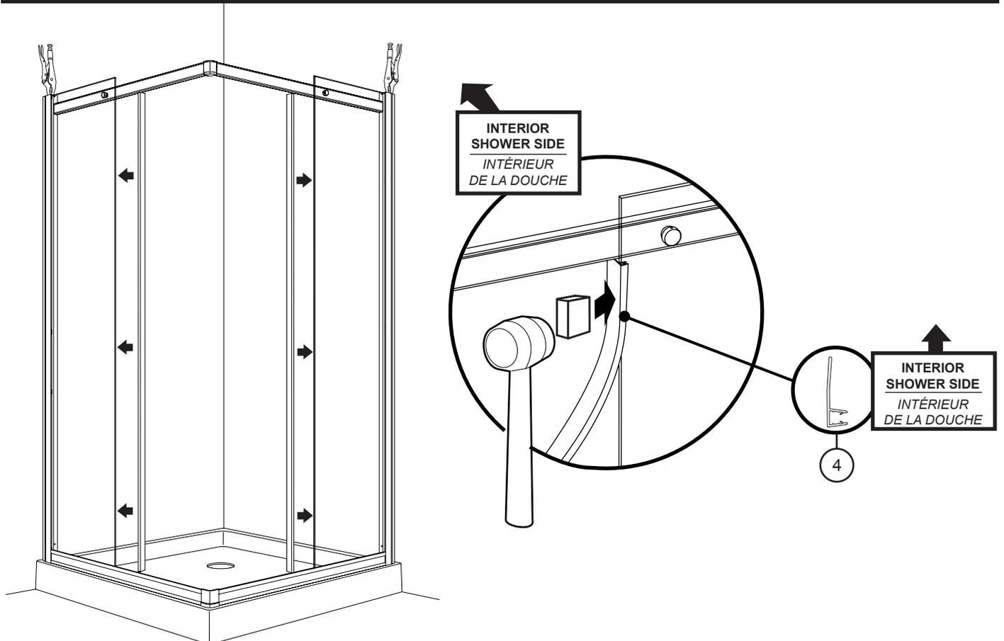
**17 LEVEL AND SECURE THE EXPANDERS / NIVELER ET SÉCURISER LES EXTENSEURS**
