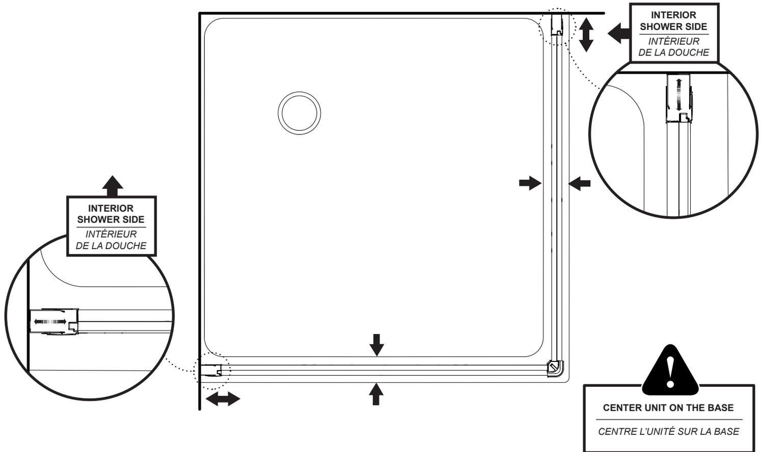
**10 SECURE THE EXPANDER & WALL JAMB WITH LOCKING PLIERS**
