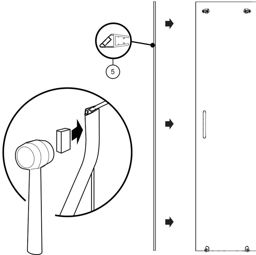
**20 INSERT DOORS INTO THE RAILS / INSÉRER LES PORTES DANS LES RAILS**
