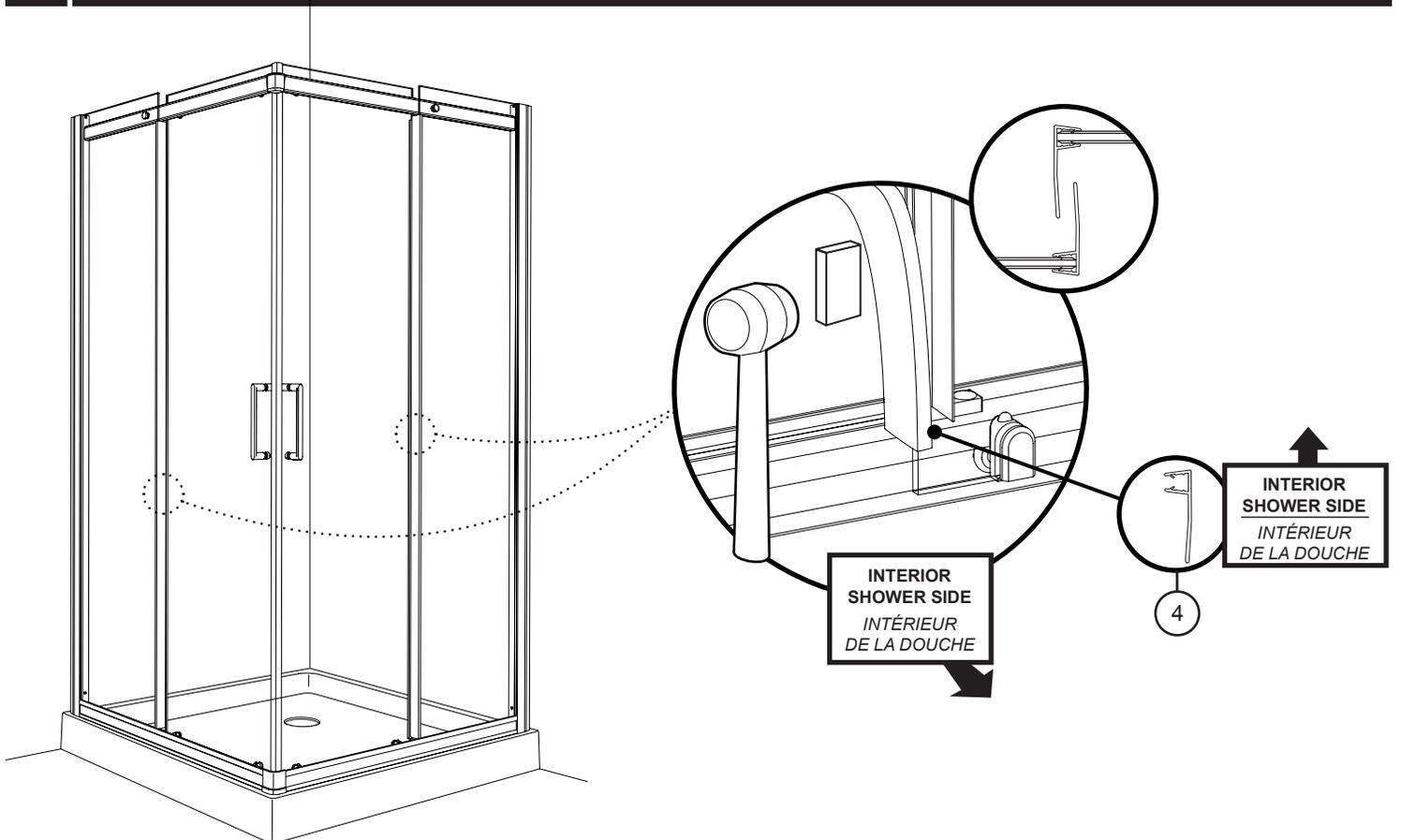
**23 INSERT HOLE PLUGS / INSÉRER LES BOUCHONS DE TROU**
