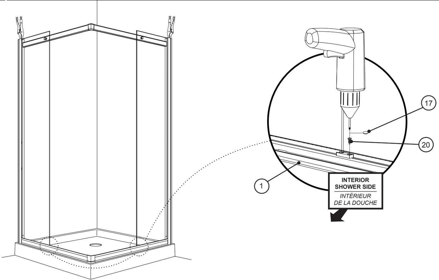
**16 INSTALL THE SIDE GASKETS / INSTALLER LES JOINTS LATÉRAUX**
