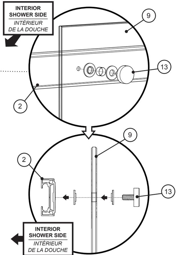
**14** **INSTALL THE BOTTOM SUPPORTS / INSTALLER LES SUPPORTS DU BAS**
